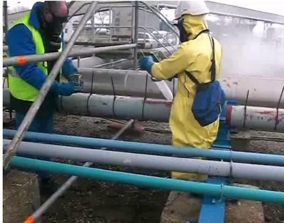
Fig. 5: Ammonia pouring test setup
