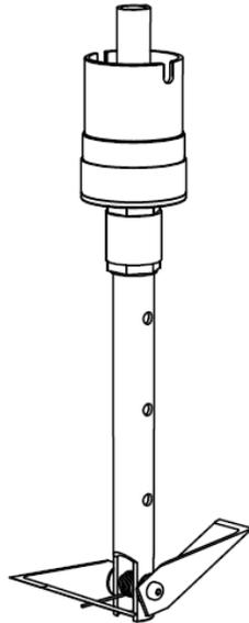
**ANCHOR GROUT VALVE WITH GASKET
